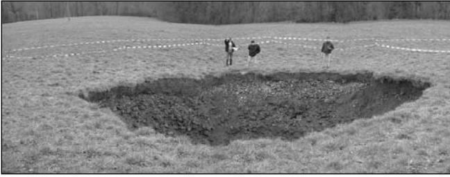
Fig. 2 : vue d'ensemble de l'effondrement dévoilant la surface elliptique (cliché : Th. Martin - 03/12/2003).
