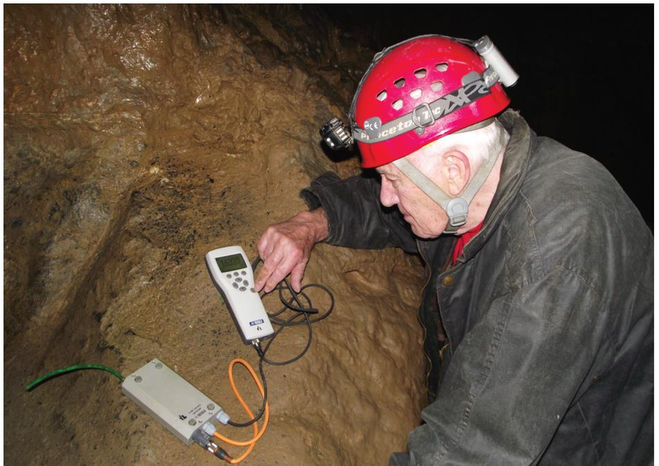
Utilisation du Vaisala MI 70 équipé d'une petite pompe à la grotte de Comblain (photo C. Ek).
