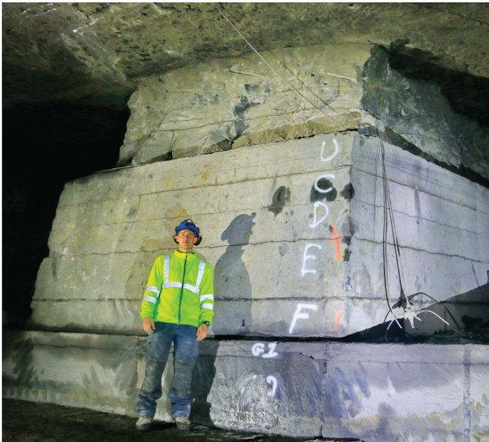
Fig. 8. Surmonté par 1 m de calcaire stérile, les niveaux exploitables (U, C, D, E, F, G) sont séparés par de fines bandes d'argile.
