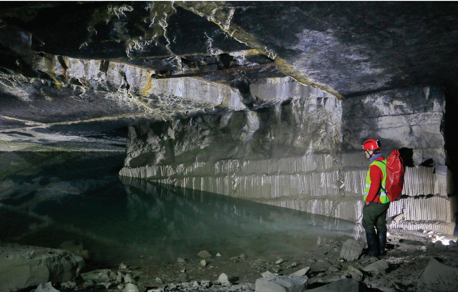
Fig. 2. Nappe d'eau dans le fond de la carrière, imposant une exhaure pour poursuivre l'exploitation.
