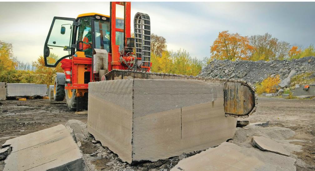
Fig. 10. Une fois en surface, la roche est égalisée et taillée à la scie diamantée. Le polissage définitif est réalisé en usine.
