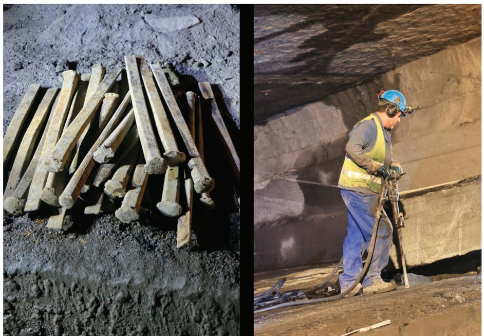
Fig. 7. Comme autrefois, c'est à l'aide de coins et du marteau-piqueur que les blocs sont détachés de l'affleurement, avant d'être remontés en surface pour un découpage et ponçage approfondis.
