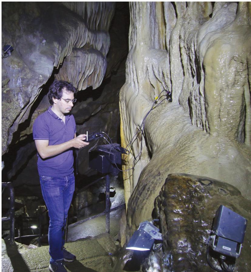
Fig. 1. Prélèvement et analyse de l'eau de percolation dans le réseau fossile de la grotte touristique de Remouchamps (Aywaille).
