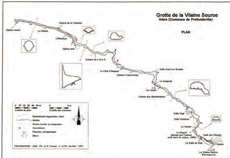
fig 5. Topographie de la Vilaine Source avec emplacement des points de prélèvement. La rivière souterraine est analysée au siphon amont (pt 8) et à l'exutoire de la cavité à la résurgence (12). Sur le parcours les spéléologues prélèvent également 3 gours (9, 10, 11) permettant de suivre la fluctuation des nitrates dans l'eau de percolation
