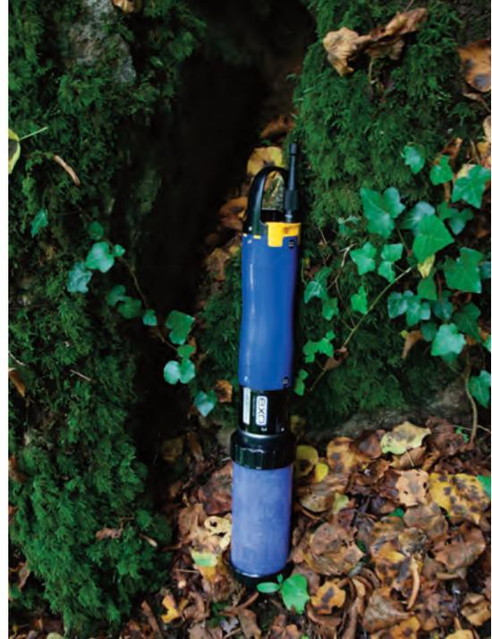
Fig. 10. La sonde « EXO » permet de mesurer toutes les 30 minutes la concentration en nitrate dans les eaux de la Vilaine Source.
