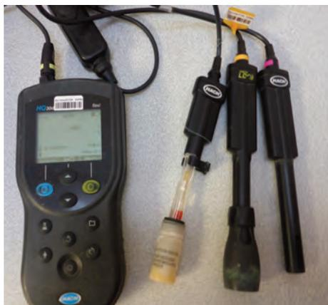
Fig. 2. Multimètre utilisé pour Epukarst comprenant notamment une sonde (droite) pour la mesure de conductivité sols (photo FP).
