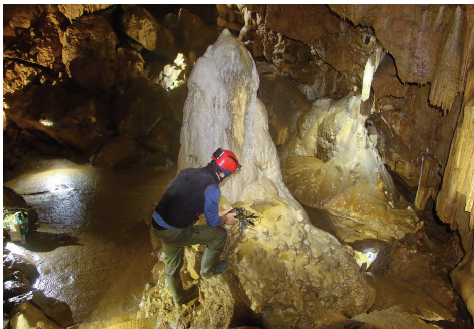
Fig. 5. Prélèvement d'eau et analyse de la conductivité et de l'oxygène dissout dans les petits gour à la base de la concrétion de la Dame Blanche.
