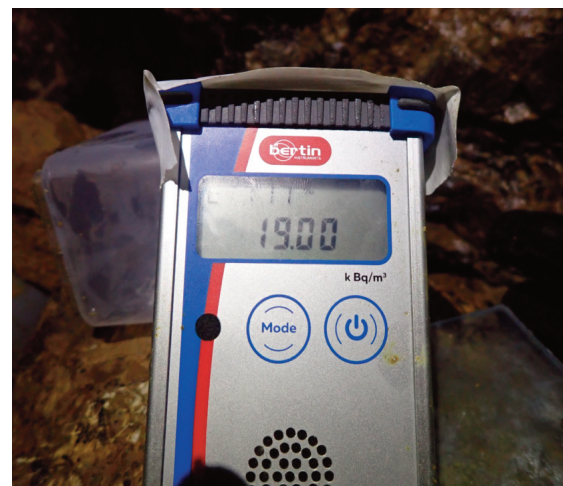
Fig 1. Datalogger enregistrant en continu des maxima de becquerel présents dans la cavité.
