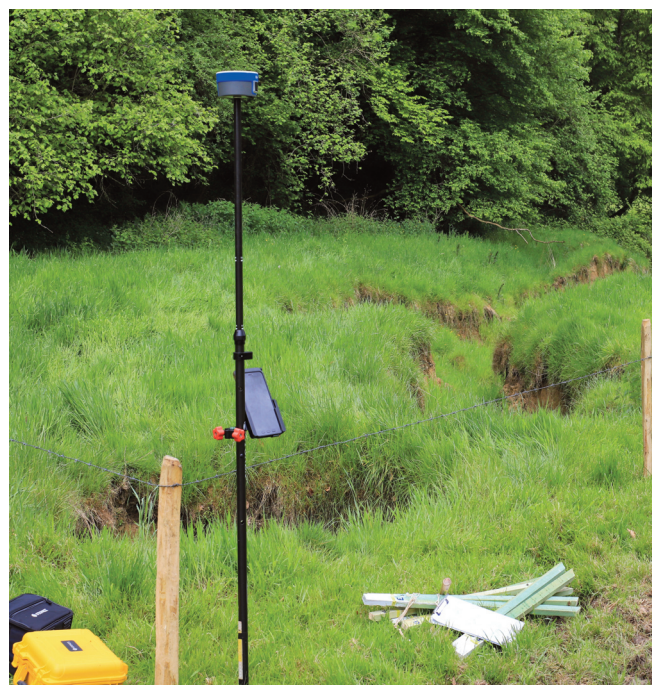
Fig. 7. Relevé à la canne GNSS des coordonnées absolues d'un ensemble de points, lignes et polygones afin de représenter le périmètre de l'effondrement.
