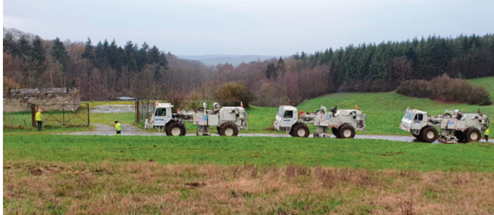
Figure 4 - Campagne de sismique réflexion GeoCOND2022 avec les camions vibrateurs passant au droit du forage d'Havelange (20 décembre 2022).
